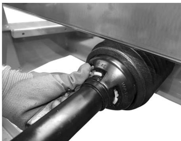
Figura 6.5: Fissare la protezione dell'albero cardanico
