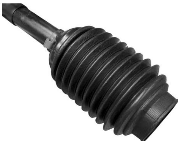
**Figura 3.3:** Protezione dell'albero cardanico
