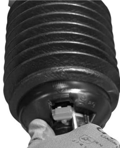
**Figura 6.1:** Aprire la protezione dell'albero cardanico
